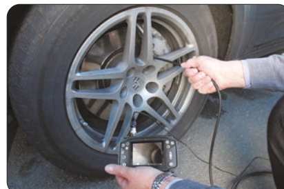
Esempio: Controllo delle pastiglie dei freni
