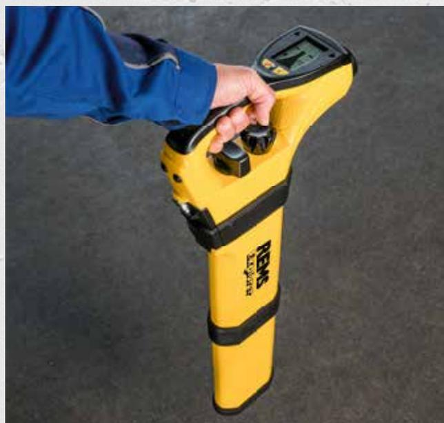
**REMS Explorer – per la localizzazione della testa della telecamera con trasmettitore 33 kHz, per definire la posizione di un danno o il percorso di una tubazione.**
